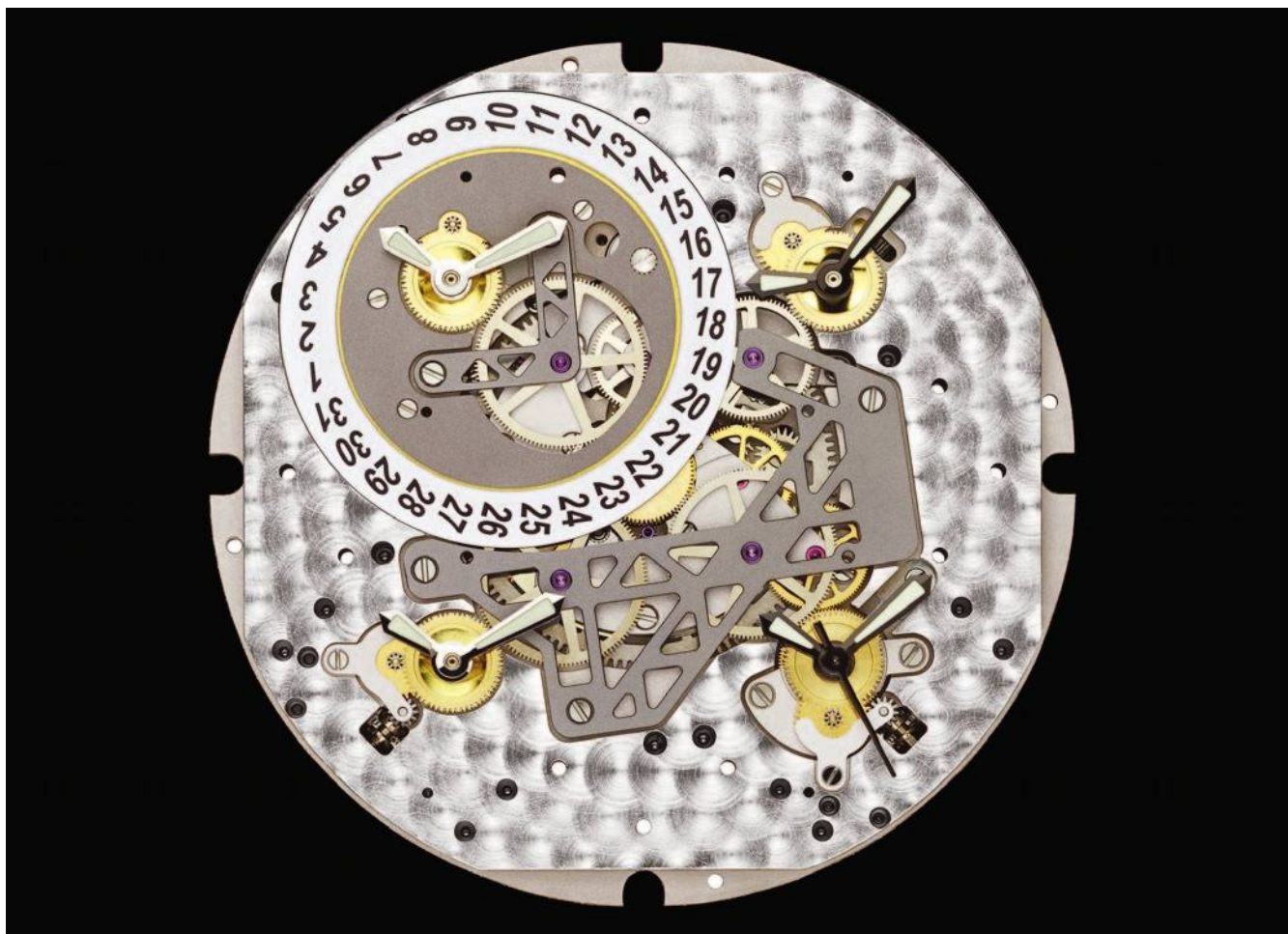
Il calibro di manifattura MV 8802 (diametro 44,30 mm, spessore 7,60 mm, 238 componenti, 33 rubini, 28.800 alternanze/ora, riserva di carica di 48 ore), meccanico a carica automatica, che equipaggia i due modelli di queste pagine.
